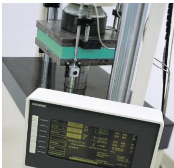
Рисунок 3 – Структура материала Sylomer под микроскопом (слева) и стенд для испытания динамических характеристик материала (справа)
